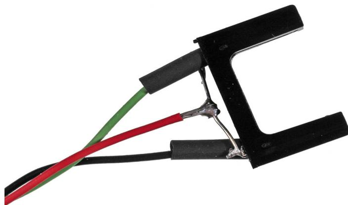
Photo-capteur infrarouge à largeur fixe de 2,5 cm environ
