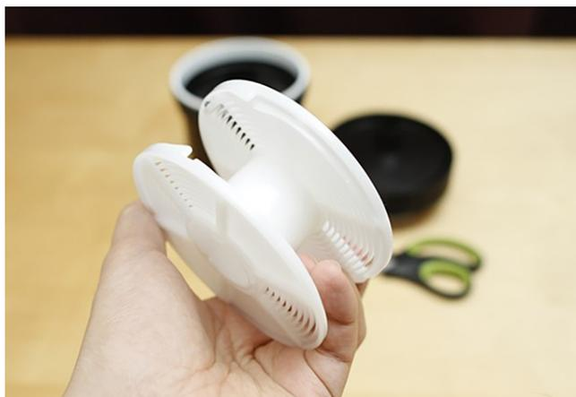
Avant de commencer, vérifiez que la spire est correctement montée, à la bonne taille et que les deux fentes d'introduction sont bien alignées. La spire doit être sèche.
